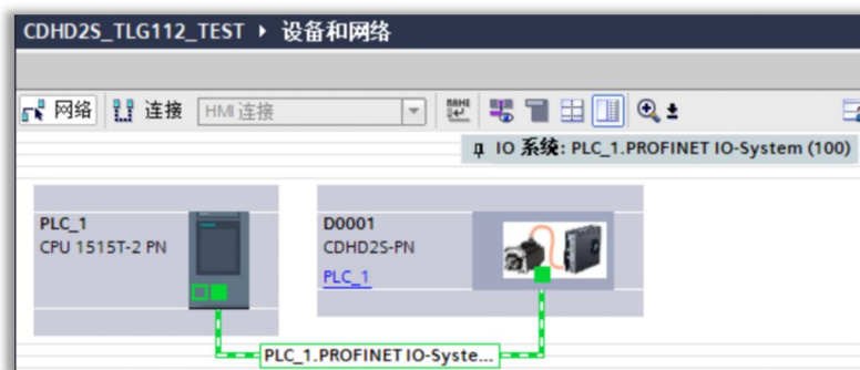
图 9-17 在网络视图添加 PLC 和高创 CDHD2S-PN 驱动器
