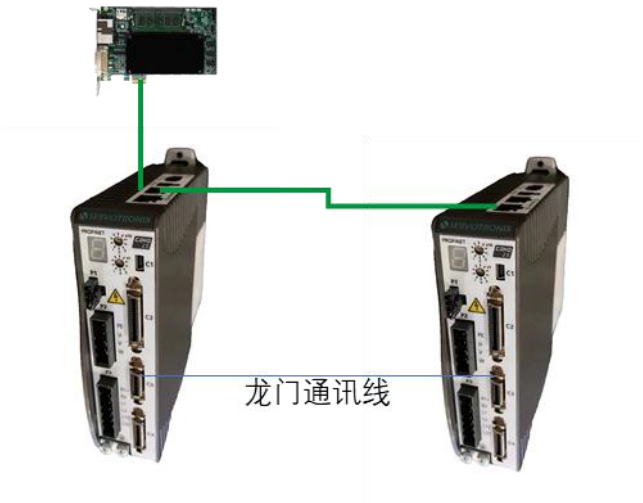
图 4-28 龙门系统接线 - PROFINET
