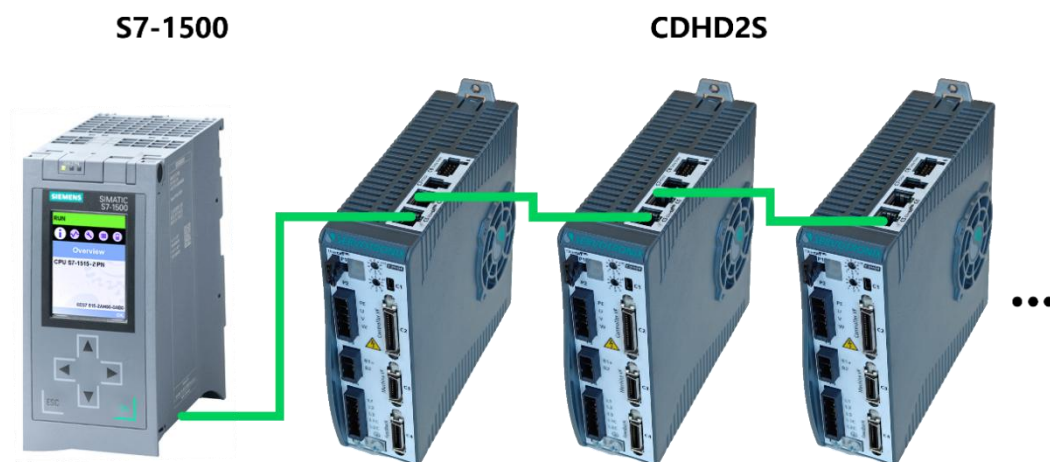
图 9-2 SERVOTRONIX CDHD2S-PN 与 Siemens S7-1500 硬件拓扑
